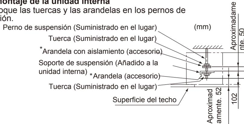
Fig. 3. 7 Tuercas y arandelas de montaje
