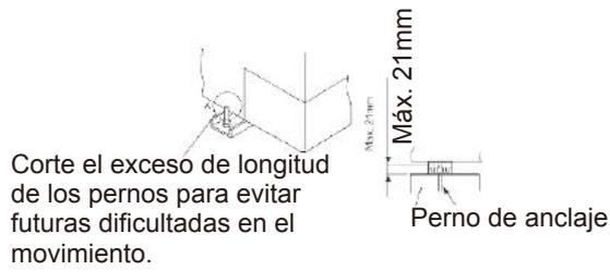
Fig. 4. 3 Instalación de los pernos de anclaje
