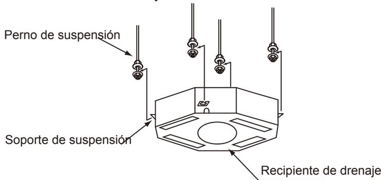
Fig. 3. 8 Montaje de la unidad interna
