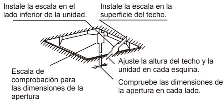
b . Techo aún no completado con paneles
